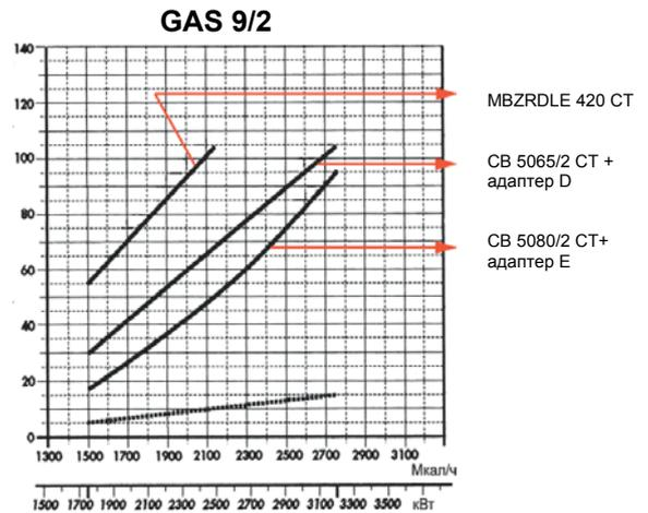
На графиках показана зависимость потери давления на головке горелки и газовой рампе (сплошная линия) и на головке горелки (пунктирная линия) от мощности теплогенератора
