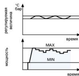
При плавном «модулирующем» регулировании горелка изменяет свою мощность в рамках диапазона модулирования, поддерживая контролируемый параметр (давление или температура) на заданном уровне. Необходимым элементом системы регулирования является датчик (температуры или давления) и электронный ПИД – регулятор (модулятор).
