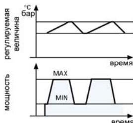
При «двухступенчатом прогрессивном» регулировании, горелка постепенно переходит с одной ступени на другую плавно изменяя мощность между двумя заданными значениями мощности.
