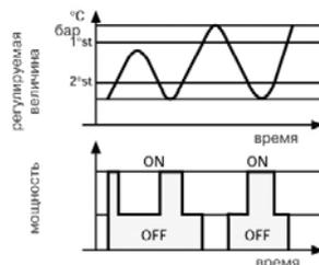
При «двухступенчатом» регулировании, горелка сразу переходит с одной ступени на другую.
